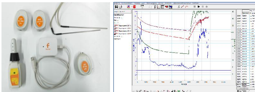
Σχήμα 1: Το σύστημα Multilog με διάφορους αισθητήρες (αριστερά) και γραφήματα με το λογισμικό του (δεξιά).
